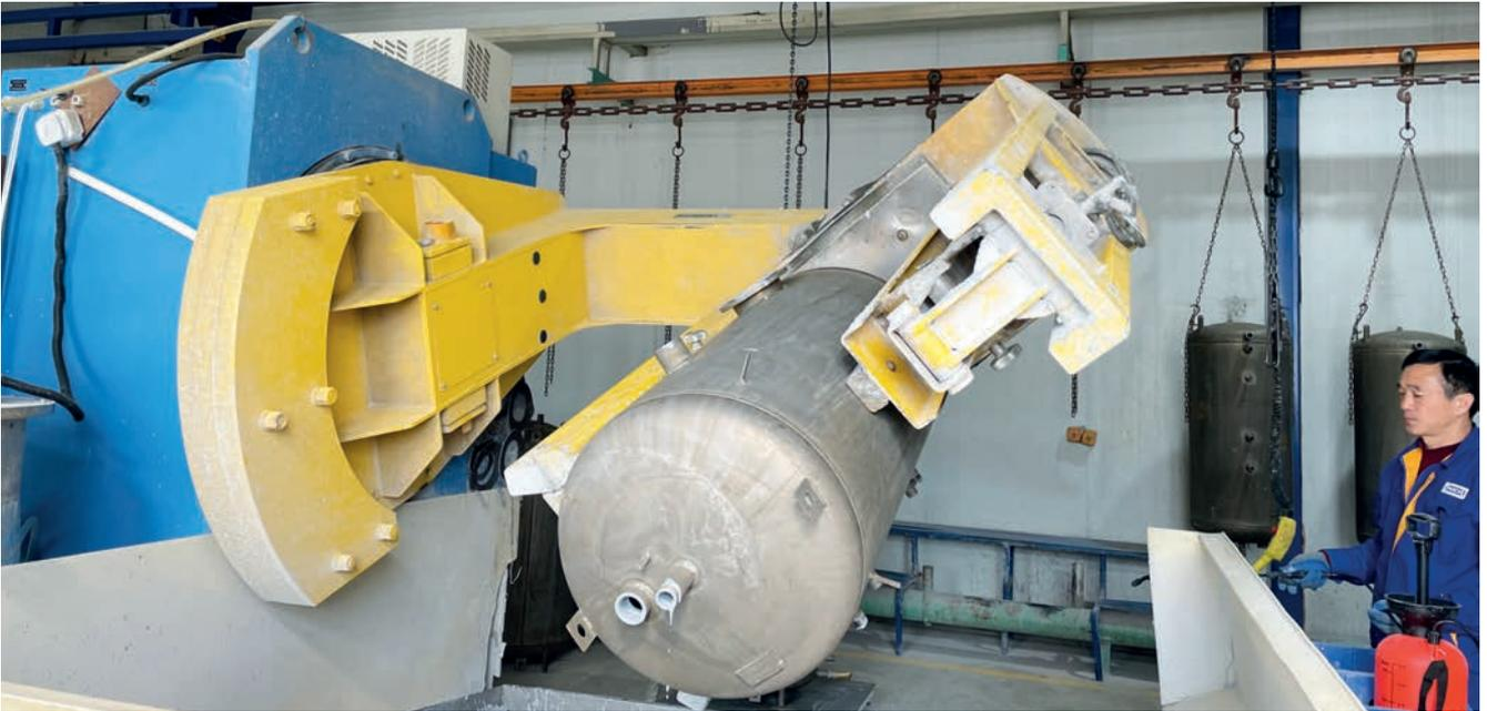
Im 3D-Verfahren wird die Emailleschicht in den Huch-Kesseln aufgetragen.
